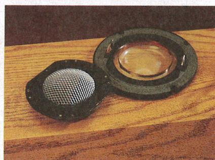
*L'esplosò del midrange ne mostra la realizzazione. La grossa griglia posteriore alla membrana svolge tra l'altro la funzione di protezione della cupola, data la morbidezza del materiale con cui quest'ultima viene realizzata, un poli-elastomero da 0,3 mm di spessore.*
